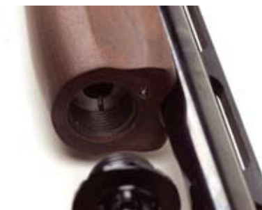
Piettan makasiiniputken hatun kierteet sijaitsevat poikkeuksellisesti putken sisäpinnassa. Myös makasiiniputken jousen pidin on kiinni samalla kiertteellä ja se voidaan avata suuhisavaimen toisella päällä.
