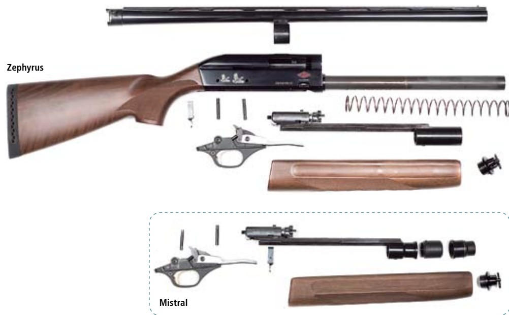
Mistralin ja Zephyruksen ainoat kuvassa havaittavat erot löytyvät piipunlenkin ja lukon välillä. Inertiatoimisissa on vähemmän osia kuin kaasulla käyvässä.
