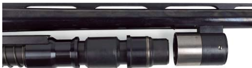
Piettan kaasumekanismi. Piipunlenkkiin on kiinnitetty kaasusylinteri ruuvein ja alumiinista valmistetussa kaasumännässä on teräksinen männänrenkas. Männän liikkeen siirtoholkkiin välittää muovirenkas, mekanismi on pitkäskuinen eikä se ole säädettävissä.
